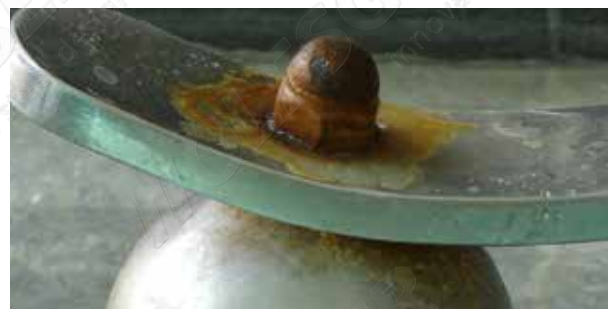
Ergebnis bei falscher Materialauswahl im Schwimmbad
