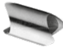
distanciateur décollé avec fraisage 90°
